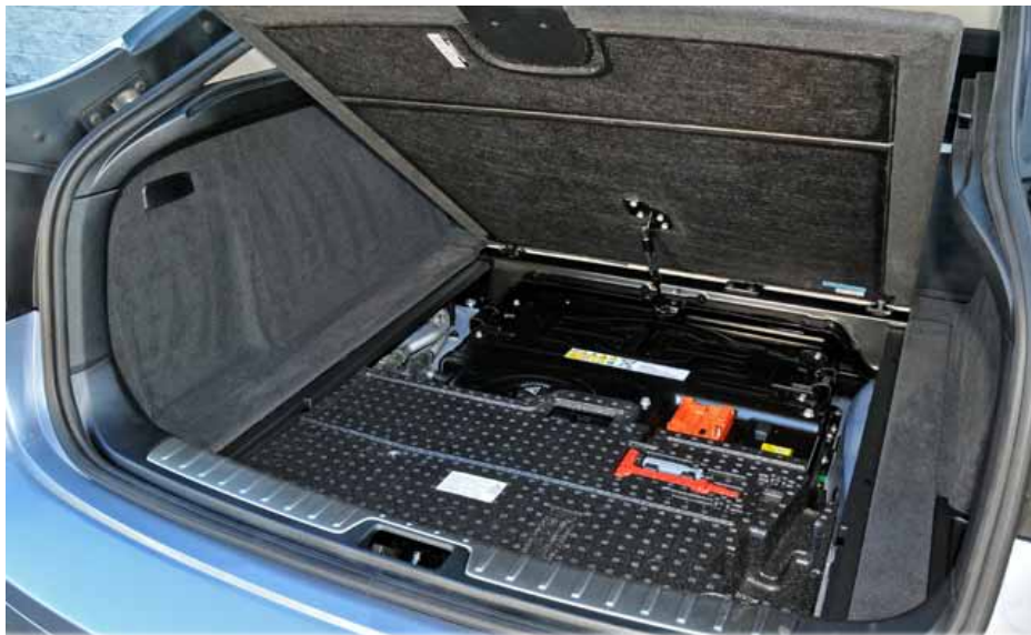
Áramtalanító a csomagtérben
